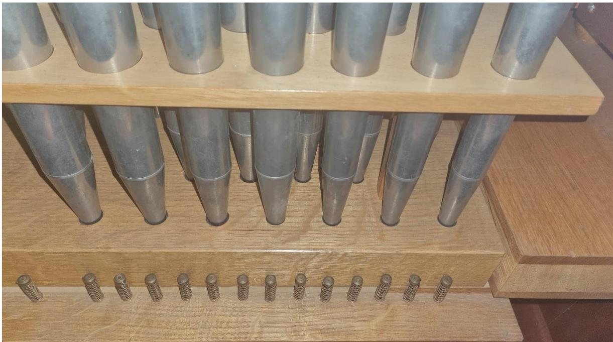
Abbildung 3: Stimmstecher für Hauptwerk und Pedalwerk
